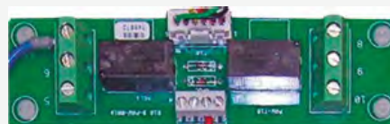
Platine mit digitalen Ein-/Ausgängen u. Relaiskontakten für T10. PAW-T10
