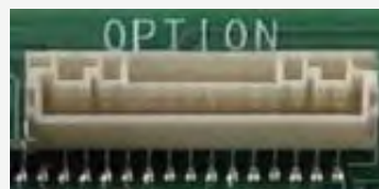
Anschlusstecker mit Litzen für PAW-OCT und PAW-FDC, bietet Option-, Lüfterantriebs- und EXCT-Funktionen. Für VRF-Innengeräte MM2, MK3, MP2 und MR2. PAW-OPT-MZ
