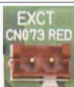
Anschlusstecker mit Litzen (2000 mm) für Thermostat-AUS- bzw. Leckdetektor-Eingang
