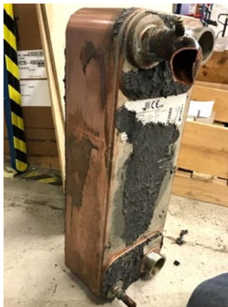
Abbildung 5.4.01: Plattenwärmetauscher mit Frostsprennung
